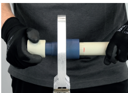
5. Pressa rör och rördel mot svetskopparna
