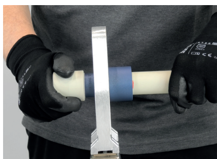
6. När rör och rördel är i korrekt position startar uppvärmningstiden
