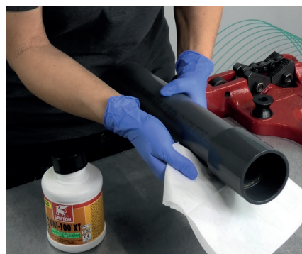
8. Torka av överflödigt lim och låt fogen vila minst 5 min innan den flyttas, vid temperaturer under +10°C måste denna tid förlängas till minst 15 min
