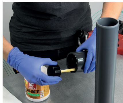
6. Applicera limmet i rördel och på röret, enligt tillverkarens instruktion. Observera penselns storlek, se tabell
