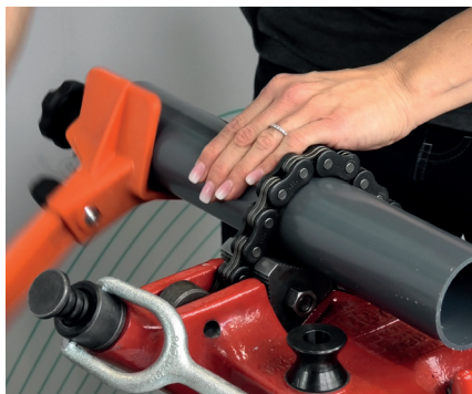
2. Fasa rörändan 15°, fasningsbredd ska vara 2-3 mm för d20-d50, 3-6 mm för d63-d225
